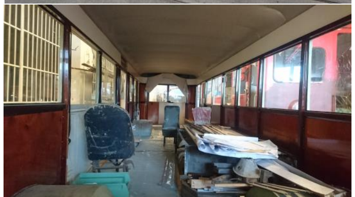
A-177 er en liten og kort buss. Bildene er tatt under omringering i 2017. Interiørbildet viser det som er ferdig av paneler, takduk og seter. Alle foto: Jon Haakon Hustad
